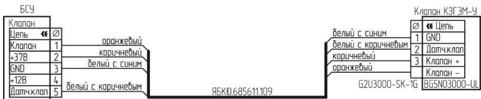
Рисунок Б.6 – Схема подключения клапана КЗГЭМ-У с разъемом BG5NO3000-UL.
