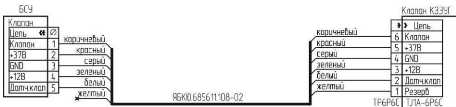
Рисунок Б.8 – Схема подключения клапана КЗЭУГ с разъемом TJ1A-6P6C.
